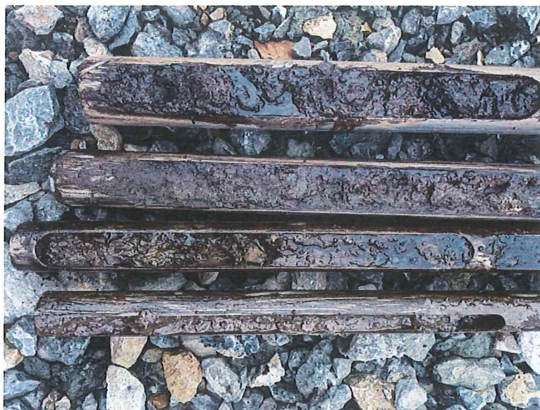
Figura 7: Forajul F1 contaminat cu ulei prezent la 1.50 m adâncime în stratul de umpluturi.
