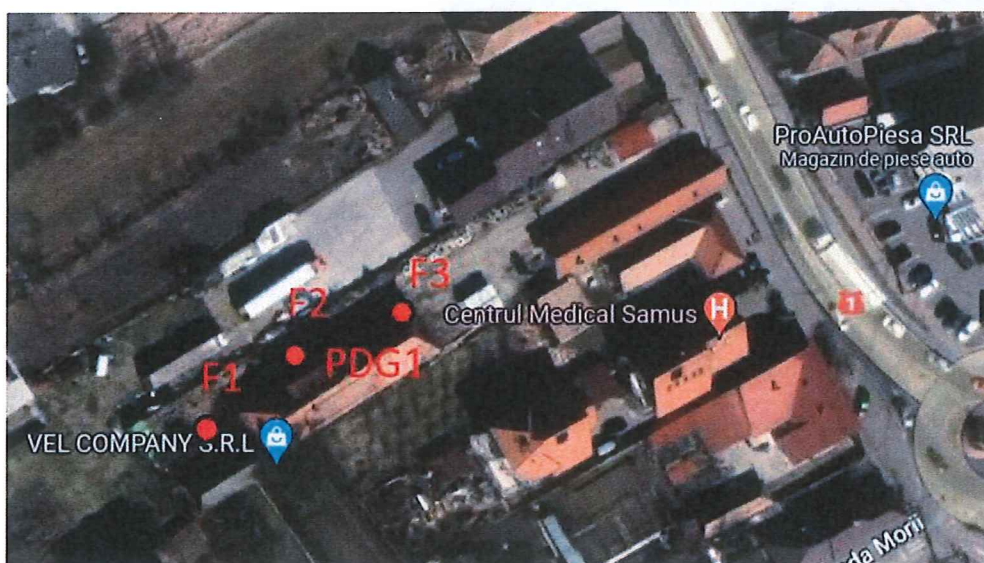
Figura 6: Localizarea amplasamentului cu poziția forajelor și a penetrării dinamice grele.
